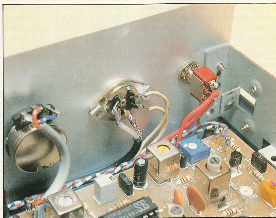
Disponiendo de un micrófono con interruptor, la entrada del micro y los cables de P1 se deben llevar a un único conector.
